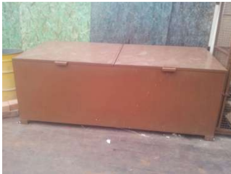
Figura 2 – Container para armazenamento de resíduos não-perigosos
